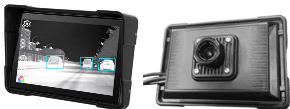
Unité principale de 5 à 7 pouces (module algorithmique intégré)
